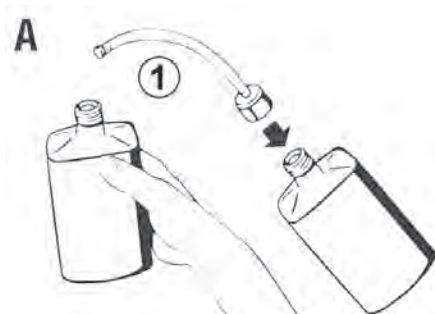
Nakręcić wąż do napełniania na butelkę
