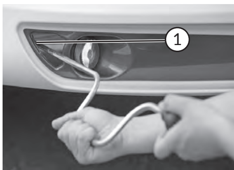
Sześciokąta śruba wykręcanych podpórek z przodu
