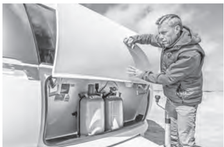
Otwieranie skrzynki na butlę gazową
