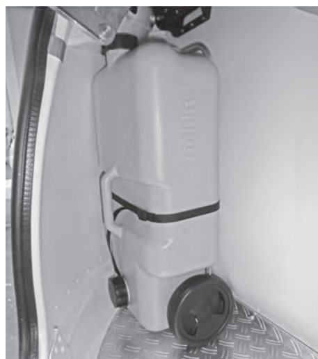
Zbiornik na ścieki w schowku na butlę gazową
