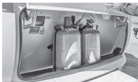
Usytuowanie butli gazowej w schowku na butlę
