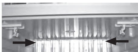
Odkrecić podstawę zamrażalnika
