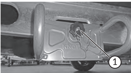
Zabezpieczenie śruby na mocowaniu koła zapasowego
