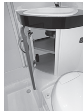
Drzwi z zamknięciem magnetycznym
