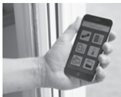
Wypoziomowanie pojazdu i wskaźnik poziomu gazu w butli aplikacji E-Trailer
