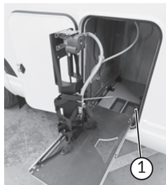
Szuflada na butlę gazową
