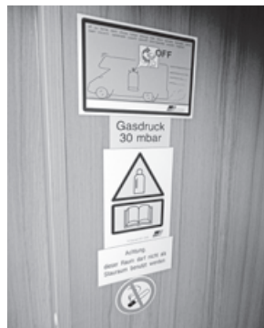
Wskazówki bezpieczeństwa widoczne w schowku na butlę gazową
